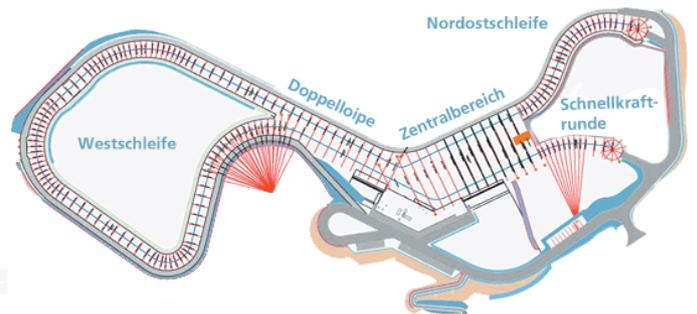
Die Loipe ist auf der gesamten Länge 8 m breit, die Schneehöhe beträgt durchgehend 30 cm. Es handelt sich um reinen Kunstschnee, der mit Hilfe eines ausgeklügelten Beschneigungssystems erzeugt wird. Je nach Bedarf kann der Schnee leicht und trocken oder schwer und nass gemacht werden.
